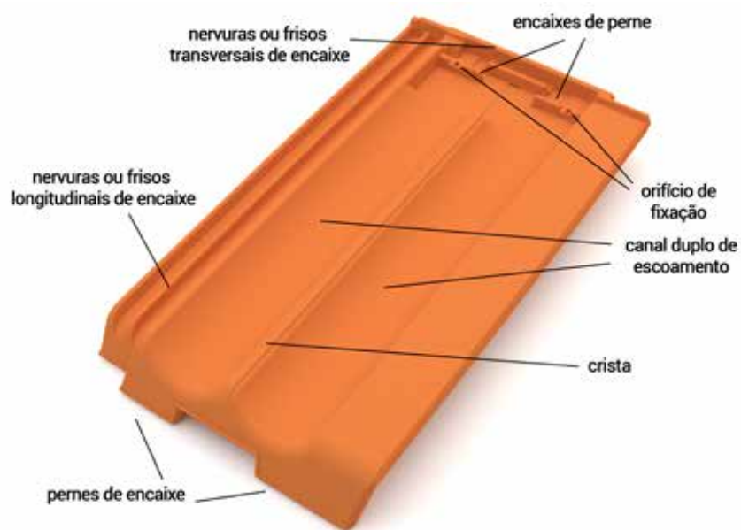
Partes da Telha Marselha
