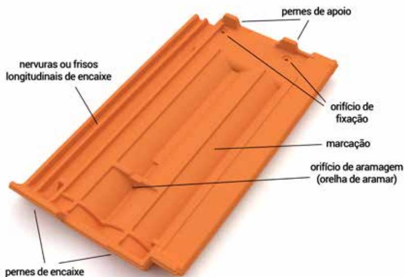
Partes da Telha Marselha
