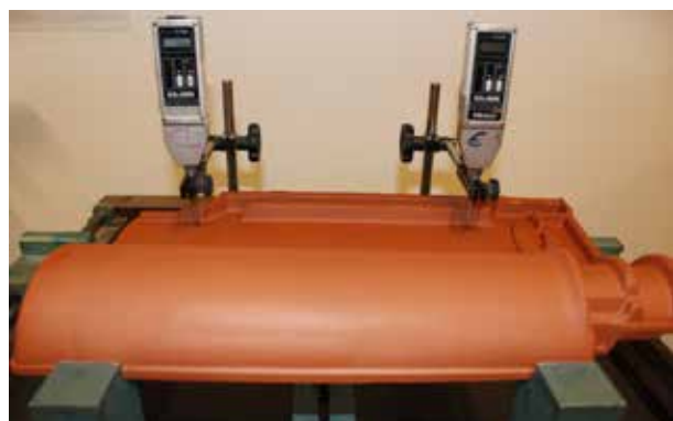
Ensaio dimensional da telha
